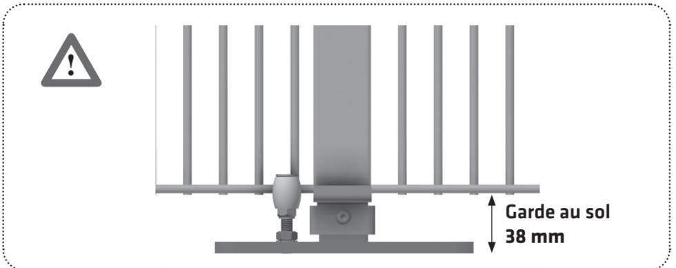
**5.3. Interface pour la fixation des dispositifs de verrouillage**
